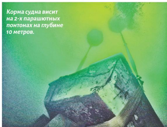
Корма судна висит на 2-х парашютных понтонах на глубине 10 метров.
