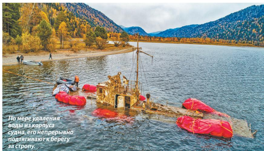
По мере удаления воды из корпуса судна, его непрерывно подтягивают к берегу за стропу.
